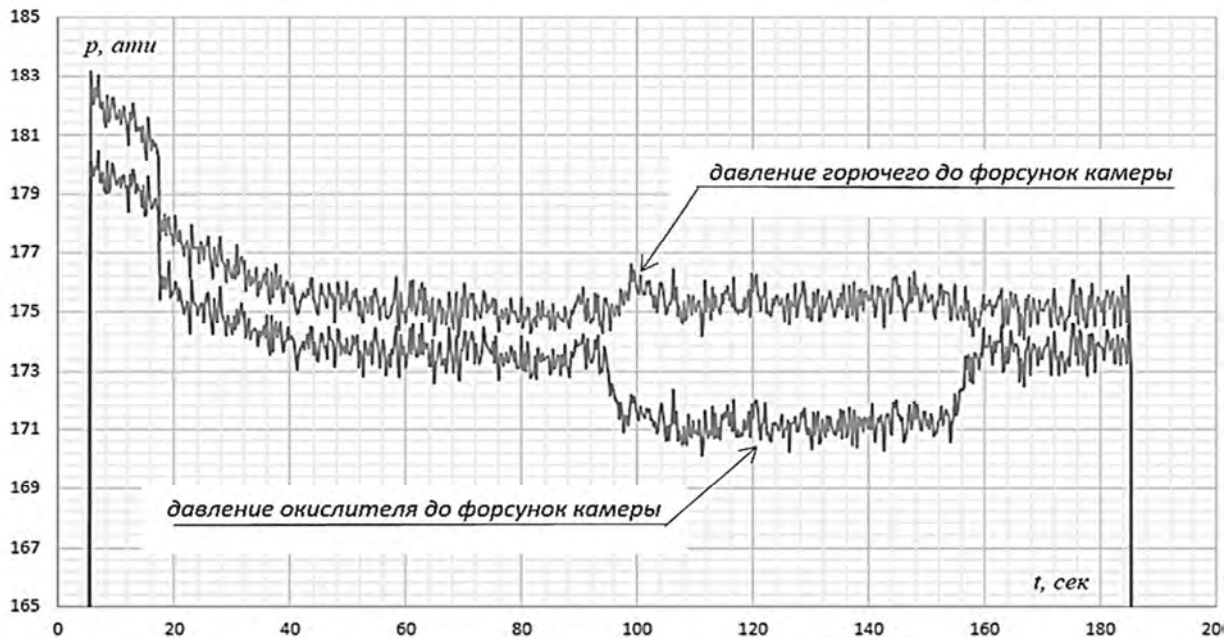
Рис. 4. Изменение давления компонентов топлива перед форсуночной головкой
